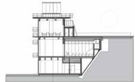
Sección transversal por sala de usos múltiples
