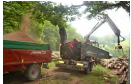
Astilladora en pleno monte
