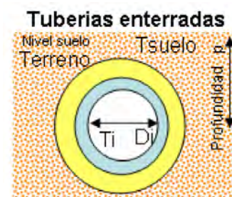
Aislamiento y pérdidas de las tuberías
