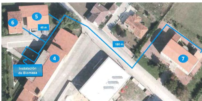
Esquema de distribución calefacción y ACS
